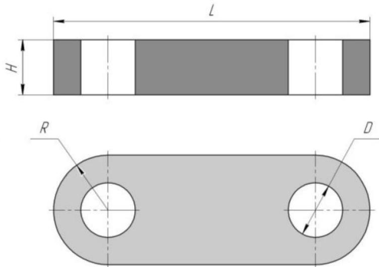
Создайте плоскую параметрическую модель детали «Опора». Размеры  $R$ ,  $H$  и  $D$  должны зависеть от размера  $L$ .
